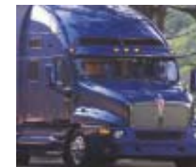
イラストの青色部分がDCPDを原料とした樹脂成型品の使用部位
