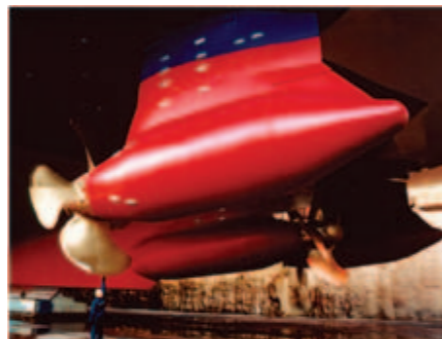
次世代型船舶用ハイブリッド電気推進システム "CRP Azipod"
