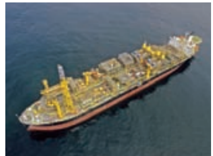
ブラジル フラージ油田 浮遊式石油生産・貯油・出荷施設
