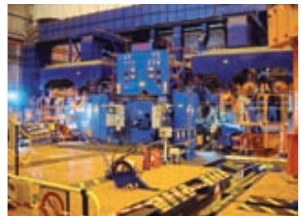
南アフリカ・コロンバスステンレス社に納入した センヂミア20段冷間圧延機
