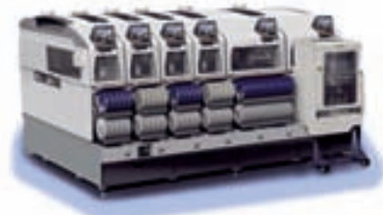
富士機械製 半導体表面実装機
