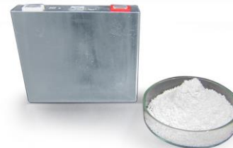
試作セルとニオブチタン系酸化物 (NTO)
